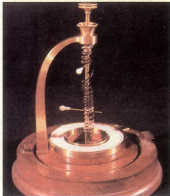
Il termometro di Jolly viene utilizzato per determinare i coefficienti di espansione dei gas.
