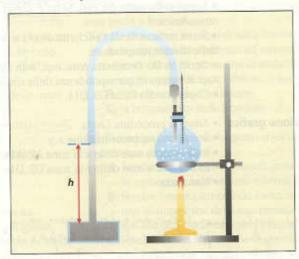
L'esperienza consiste nel rilevamento della pressione del vapore saturo come differenza di quella letta al barometro  $p_a$  (in mm) e l'altezza h raggiunta dal mercurio nel tubicino.
