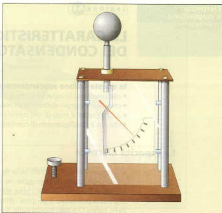
6. Elettrometro. La funzione dell'elettrometro è quella di misurare le differenze di potenziale in condizioni elettrostatiche. Il disegno schematicizzato mostra la forma più comune di elettrometro: esso è costituito da un ago di filo di quarzo metallizzato opportunamente incernierato all'asta che comunica con l'esterno. La posizione dell'ago si osserva direttamente su una scala graduata.
