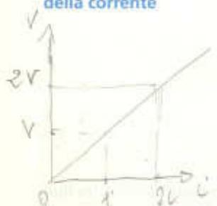
**a parità di  $\Delta V$ , conduttori diversi sono attraversati da correnti elettriche di intensità diverse.**
